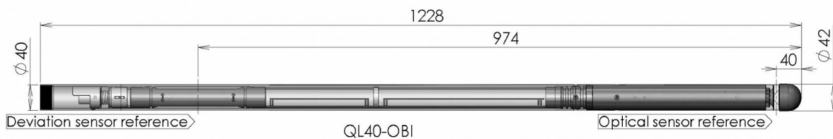
1. Schema della sonda ottica per sondaggi OBI40-2G.
