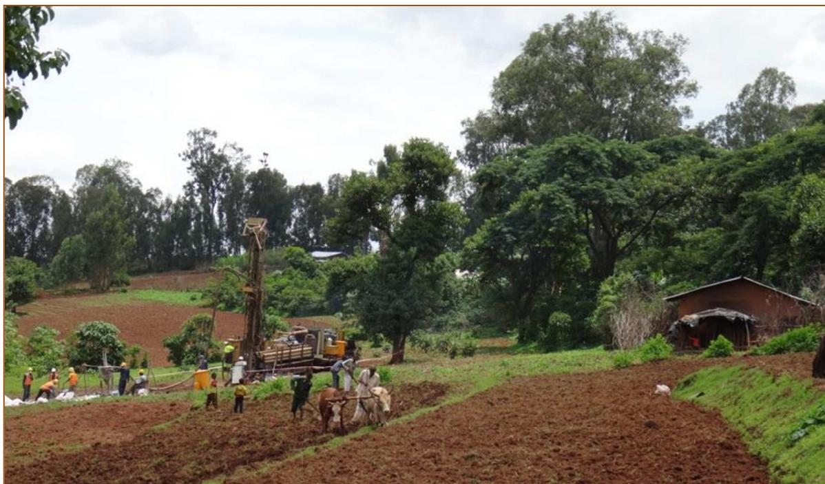
**Figura 13:** Esecuzione di un sondaggio a circolazione inversa presso il versante meridionale di Tulu Kapi
