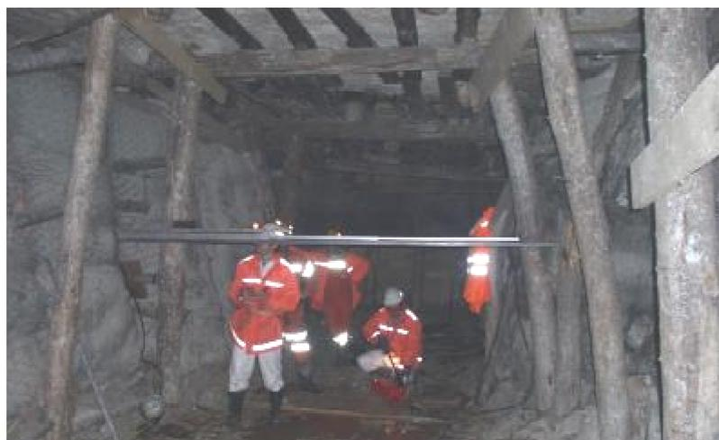
Fig. 11. Esempio di una trancia sotto talco bel quale sono in corso prove di carico sui quadri in legno da parte dei tecnici del Politecnico di Torino
