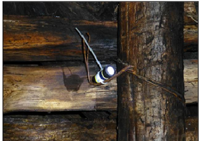
Fig. 12-13: rappresentazione schematica del sistema di ventilazione (assonometria), anno 1960 e misuratore di radon (cartuccia) posizionato in sotterraneo (2015)
