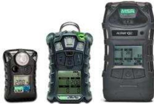
Fig. 5 – Misuratori di gas MSA, da sinistra Altair Pro, Altair 4x e Altair 5x.
