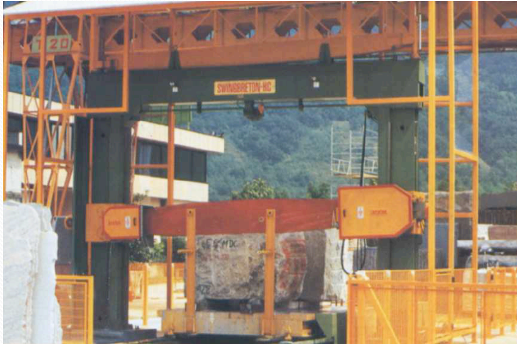
Segatrice a catena diamantata per blocchi di granito "Swingbreton HC" (fonte: Breton S.p.A., 1995).
