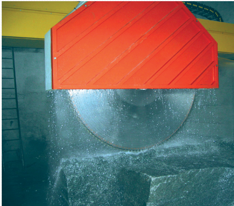
Modello di fresa a disco gigante (fonte: Primavori, 2008).
