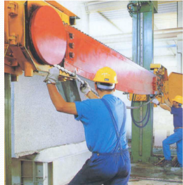
Segatrice a catena diamantata per blocchi di granito "Swingbreton HC" (fonte: Breton S.p.A., 1995).
