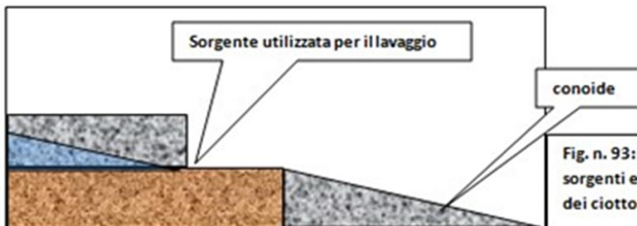
Fig. n. 93: lavaggio della sabbia aurifera sfruttando la portata delle sorgenti e formazione delle conoidi di lavaggio. L'allontanamento dei ciottoli non ostacola un totale sfruttamento del placer aurifero.
