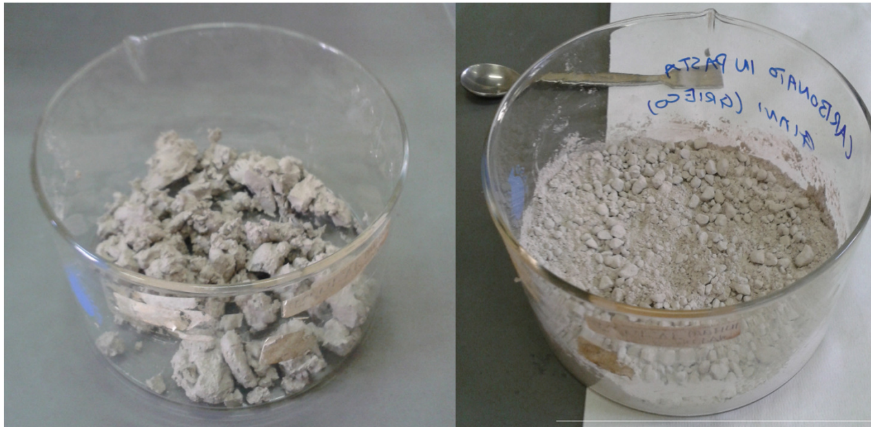
Fig. 7: Carbonato di calcio usato per il tamponamento. A sinistra: stato iniziale umido, pastoso. A destra: materiale essiccato.
