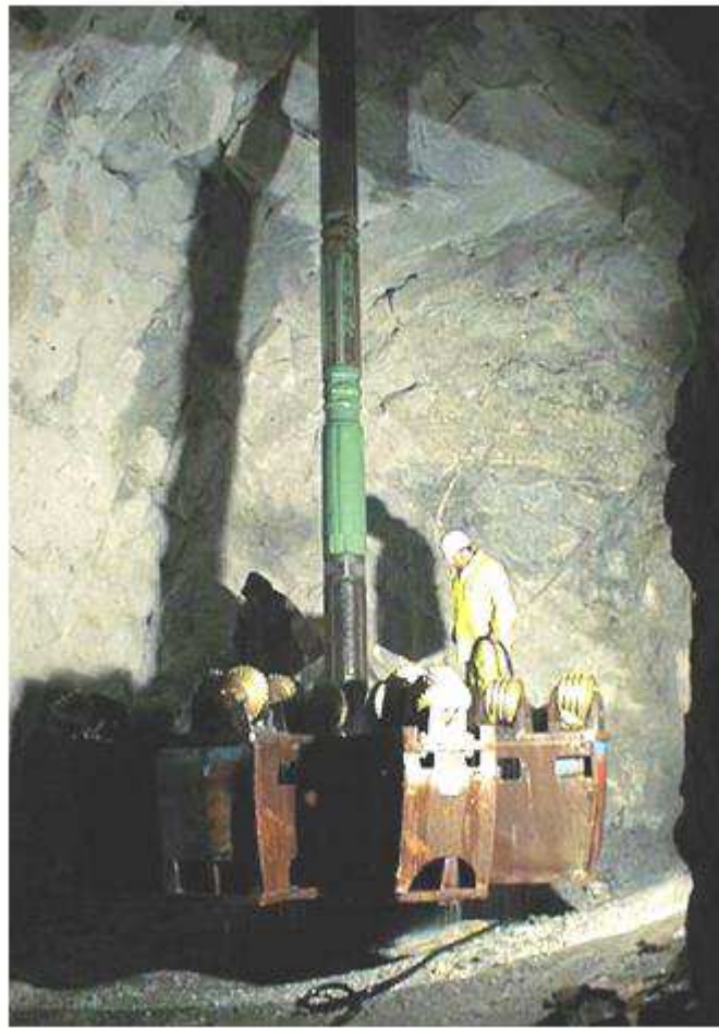
Particolare fase di alesaggio – realizzazione Fornello
